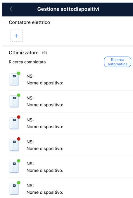
**Passaggio 7** Nella schermata di messa in servizio dei dispositivi, scegliere **Manutenzione > Layout dell'ottimizzatore**, selezionare il modulo FV corrispondente e associare il nuovo ottimizzatore in base alle informazioni di mappatura registrate. Toccare **Invia**.
